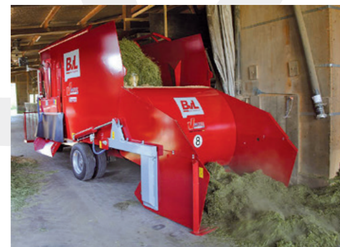
Tête automotrice électrique MULTI utilisée avec une mélangeuse d'aliments BvL V-MIX FILL Plus 17-2S L avec porte de chargement.
