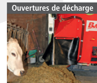
Gauche / droite, avant / arrière / de côté, avec glissières ou élévateurs
