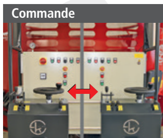
Commande ergonomique avec vol- lant, coulissant à gauche / à droite
