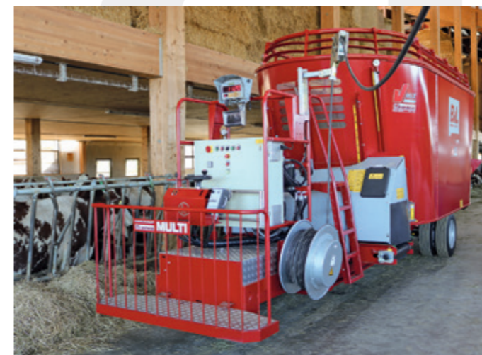
Tête automotrice électrique MULTI avec moteur-réducteur de 30 kW monté sur une mélangeuse V-MIX Plus 24-2S BvL avec tapis transversal à l'avant.
