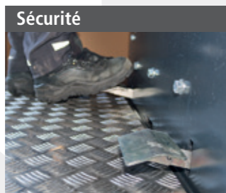
Commande homme-mort: frein de service et de stationnement autom.
