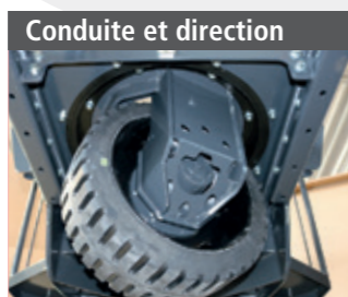
Moteur-réducteur de roue avec frein autom. et angle de braquage d. +/-70
