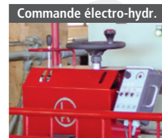
Commande électro-hydr. pour plus de deux fonctions sur la mélangeuse
