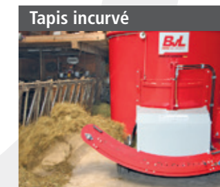
Mangeoires jusqu'à 90cm, réglable gauche/droite, hydraul. en option
