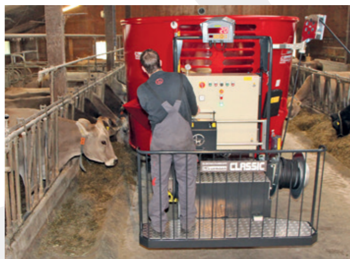
Le poste de conduite protégé, le frein de service et de stationnement automatique, ainsi que la bonne vue d'ensemble génèrent de la sécurité lors du travail.
