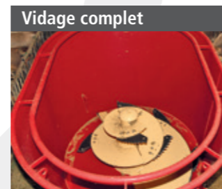
Le vidage rapide avec rapport 1:3 em- pêche l'échauffem. du fourr. résiduel
