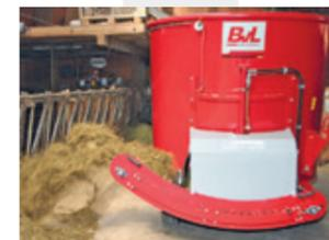
Das Bogenband ermöglicht den Austrag in Futterkrippen bis 90cm Höhe.
