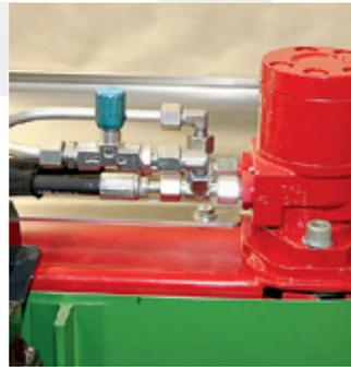
Antrieb hydraulisch mit stufenloser Geschwindigkeitsverstellung
