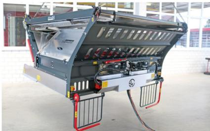
Der **Auf- und Abbau** der gesamten Dosieranlage erfolgt werkzeuglos in 15 Minuten. Bei der Entwicklung wurde ein Hauptaugenmerk auf die freie Sicht von der Schlepperkabine zu den Einzugsorganen der Presse und die einfache Umstellung gelegt.
