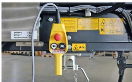
Die Steuerbirne ist ausschliesslich zur Bedienung der Rotoren und beinhaltet die Funktionen «Rotor links Stopp/Rückwärts» und «Rotor rechts Stopp/Rückwärts». Die weiteren Funktionen («Rotoren auf/zurück», «Zuführband vor/zurück» und «Rutsche auf/ab») werden über die Steuergeräte des Schleppers bedient. In der Basisvariante sind demzufolge 4 DW-Steuergeräte erforderlich!
