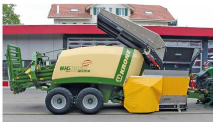
Das Futter soll vom **Bunker** durch das **Dosiergerät**, auf dem **Zuführband**, an den **Speed-Drums** bis zur Übergabe an die **Pick-Up** eine kontinuierliche Beschleunigung erfahren.
