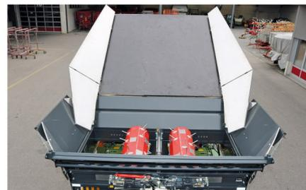
Die Rutsche besteht aus klappbaren mehrteiligen Aluseiten-Wänden und kann hydraulisch um 180° auf das Dosiergerät geklappt werden.
