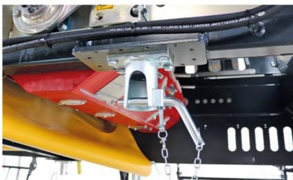
Für den kurzfristigen Feldeinsatz kann das Einzugsband innerhalb von 5 Minuten demontiert werden und das Arbeiten ohne Sicht Einschränkung auf die Einzugsorgane ist möglich.
