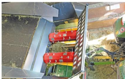
Das **Dosiergerät** bildet das Kernelement. Die neu entwickelten Rotoren, mit gesteuerten Stahlzinken und integrierter Verlustsicherung, ermöglichen einen effizienten, schonenden und wickelfreien Dosierprozess bei geringstem Energieaufwand. In Kombination mit dem neuen, grossvolumigen Bunker werden auch in schwierigen Futterbeständen ansprechende Durchsatzleistungen erzielt. Der Eingriff der Stahlzinken kann werkzeuglos verstellt werden.
